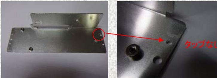
発生原因 : ヒートシンクメーカー、作業者変更時に作業指導ミス。
